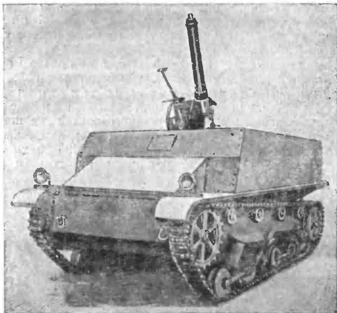
Рис. 59. 40-мм английская самоходная противотанково-зенитная пушка в положении для зенитной стрельбы.
