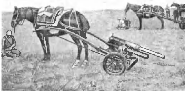
Рис. 30. 47-мм швейцарская пушка завода Тун в походном положении.
